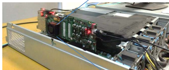
基于x86商用服务器及 自研FPGA板卡实现
